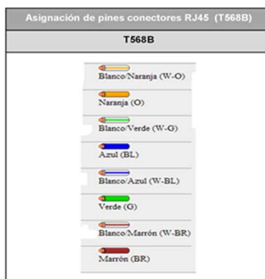
Figura 5. Asignación de pines a conectores RJ45
